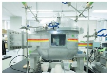
ラボ汎用機 電子レンジタイプ (約100g/batch)
